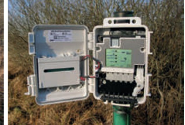
Hidrometrija Kolišče 1, a) piezometer z nameščenim avtomatskim hidrografom b) kontrolni-krmilna enota
